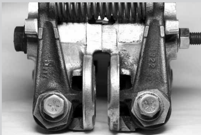
Vista frontale di una pinza smontata dal cambio, sono chiaramente visibili gli eccentrici e le leve
