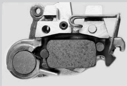
una mezza pinza separata dall'altra metà con le due pastiglie separate: quella per il freno idraulico e la piccola tonda per il freno a mano
