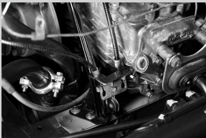
La leva di comando sul telaio con il bilanciere e i cavi di comando
