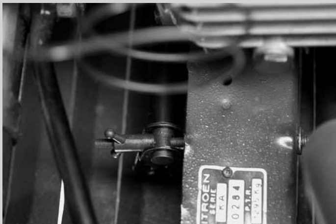
Galletta di regolazione di uno dei due cavi con vecchi freni a tamburo
