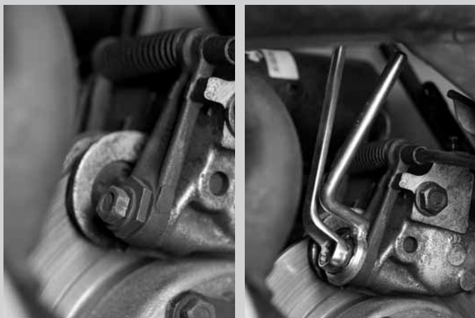
Le leve sulla pinza sinistra e l'eccentrico esterno su impianto con freni a disco
