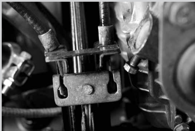
Dettaglio del bilanciere che ripartisce il tiro tra i due cavi
