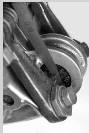
lo spessimetro infilato tra leva e pastiglia per eseguire la regolazione secondo i manuali
